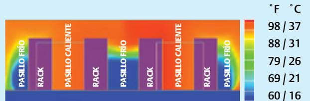
**Carga de calor = 6 kW por rack con la configuración de pasillo frío/caliente.**
